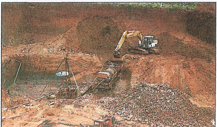
Exploitation mécanisée dans le placer éluvial à saphir de Bang Kacha, Thaïlande du Sud-est - Photo : D. Schwarz.
