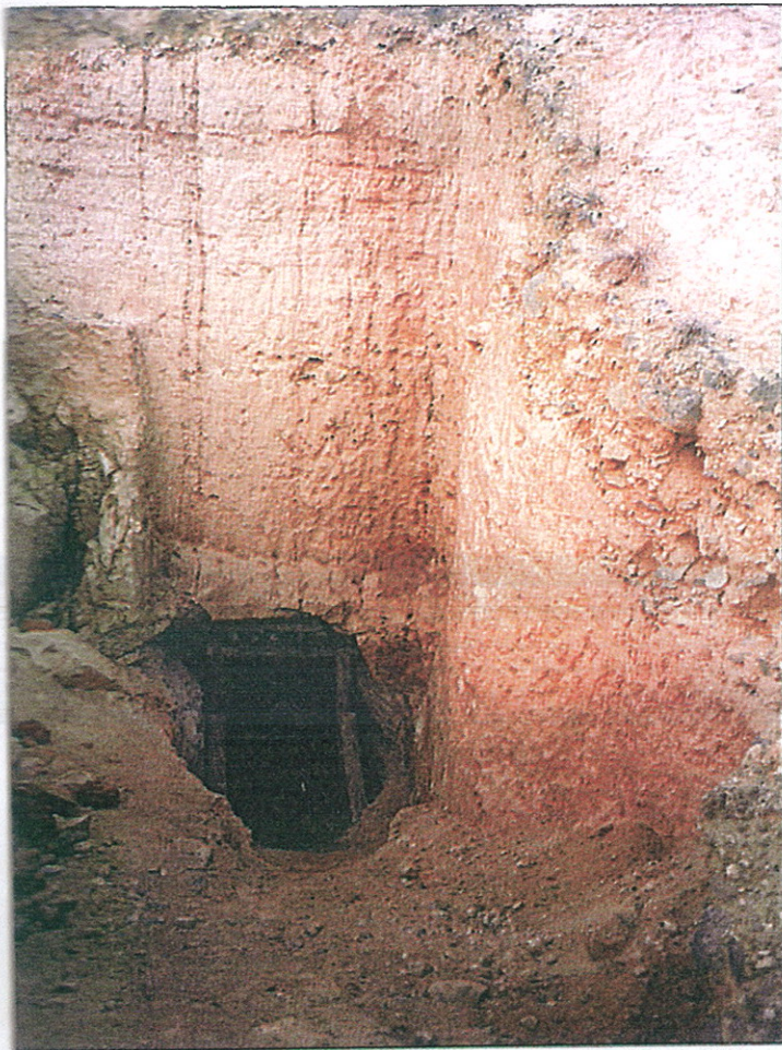
Exploitation par une galerie étayée, dans le placer de Vohimena Talo. Photo : V. Garnier.
