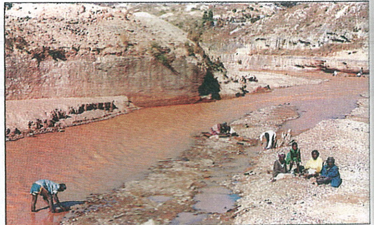
Lavage à la rivière par batoyage des galets et sables minéralisés, village de Vohimena Talo - Photo : V. Garnier.
